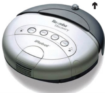
iROBOT Roomba Discovery שואב אבק רובוטי בעל פגוש פלטטיק העוקב אחר קירות
